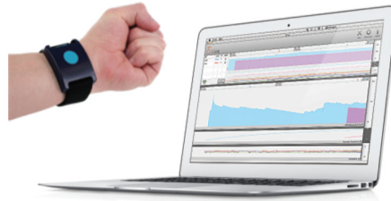
Figura 1: Sensor fisiológico para medição da EDA [Afectiva 2013]
