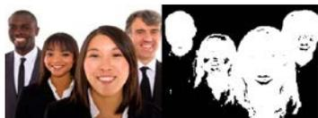
Figura 12: Teste de reconhecimento de cor de pele com o sistema YCbCr
